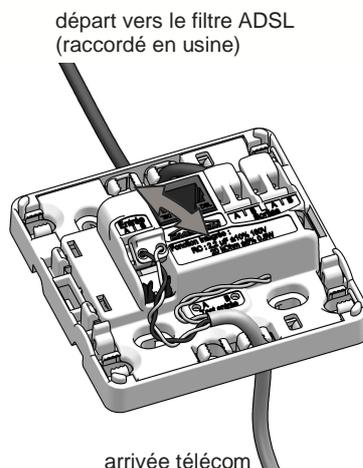
2 - Raccorder l'arrivée télécom sur le bornier de connexion auto-dévidant.
