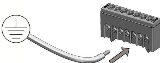
Raccorder le bornier à la terre.
