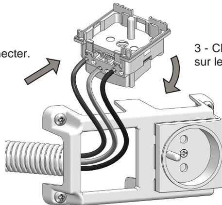
3 - Clipper le mécanisme sur le support.
